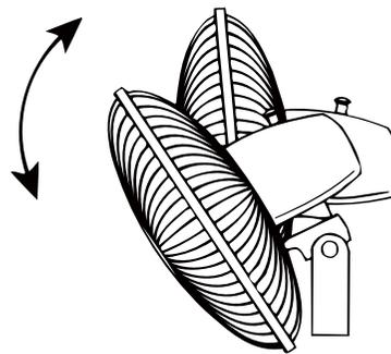
運転を停止して羽根が完全に止まってから本体を押さえながら上下に動かしてください。
