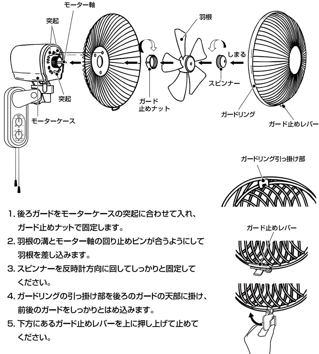
1. 後ろガードをモーターケースの突起に合わせて入れ、ガード止めナットで固定します。
